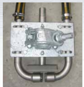
OLAS Messkopf wird mittels Standard-Gerüstschelle am Halterungsrohr befestigt
